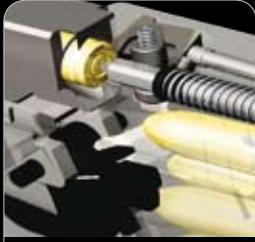
Schlagbolzensicherung in gesichertem Zustand
