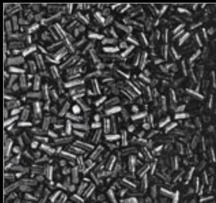
also bei Hochleistungsmunition mit gestreckter Flugbahn, reicht die Energie der reinen Nitrozellulose nicht mehr aus. Man erhöht sie durch Zugabe stärkerer Energie wie Nitroglycerin oder ähnlicher Stoffe. Alle Treibladungspulver unterliegen ohne Ausnahme den Auflagen des Sprengstoffgesetzes.
