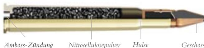
Einfüllen des Pulvers, dem Setzen des Geschosses bis hin zur Einstellung der Patronenlänge und dem Kneifen des
