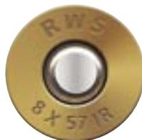
die Patronen mit dem größeren Geschossdurchmesser die Zusatzbezeichnung S. Neben diesem S in der Kaliberbezeichnung weisen die Patronen bei RWS zusätzlich die schwarze Lackierung der Ringfuge am Patronenboden auf.
