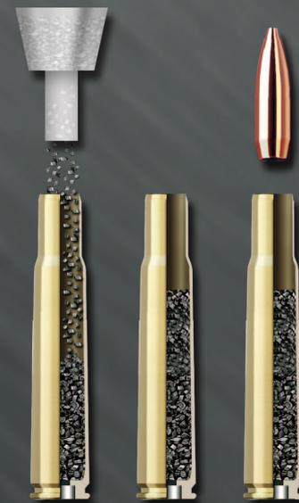
1. Dosierte Pulverzuführung
