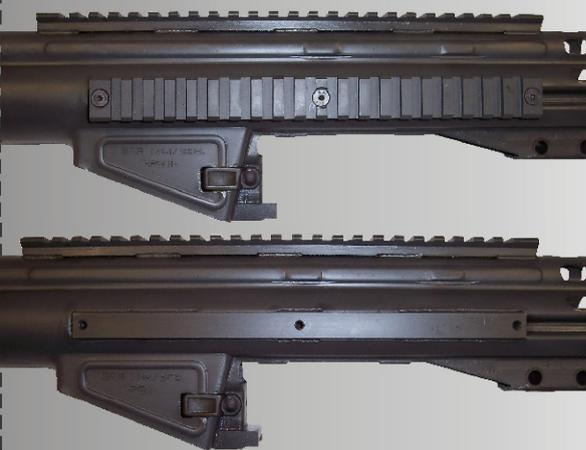
Seitlich je eine Versteifungsschiene 215 mm lang.
